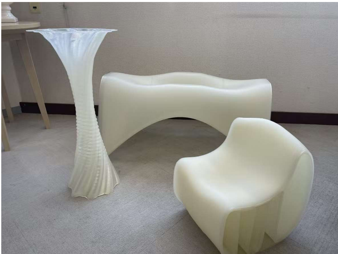
新潟タキザワが3Dプリンターで製作したイスとテーブルの脚。材料は植物由来の生分解性プラスチック
